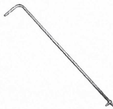
Рисунок 13 - Трубка напорная (пневтометрическая) модификации Пито (с изогнутым носиком), исп. В
